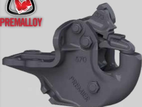
Lorsque le passage vertical est problématique, le 570 et le 770 sont la solution. Notre 570 est doté d'un cylindre pneumatique à montage par le bas et d'un système de verrouillage compact et solide. Le graisseur fourni permet de lubrifier rapidement et facilement le loquet.
